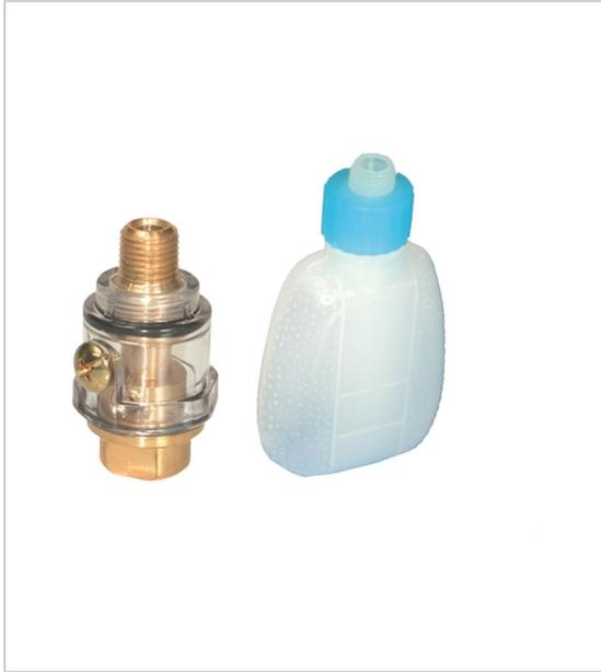
Huileur à fixer directement sur les outils (filetage 1/4), se visse sur l'entrée d'air d'un outil air comprimé, juste avant le raccord.
