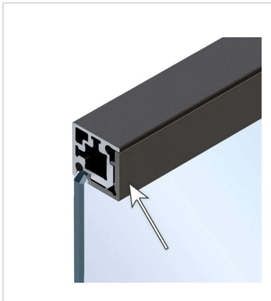
Pour fixer un élément vitré (verre de sécurité trempé) de 4 mm, l'autre côté du profilé étant fermé (par ex. pour une surface de porte)
