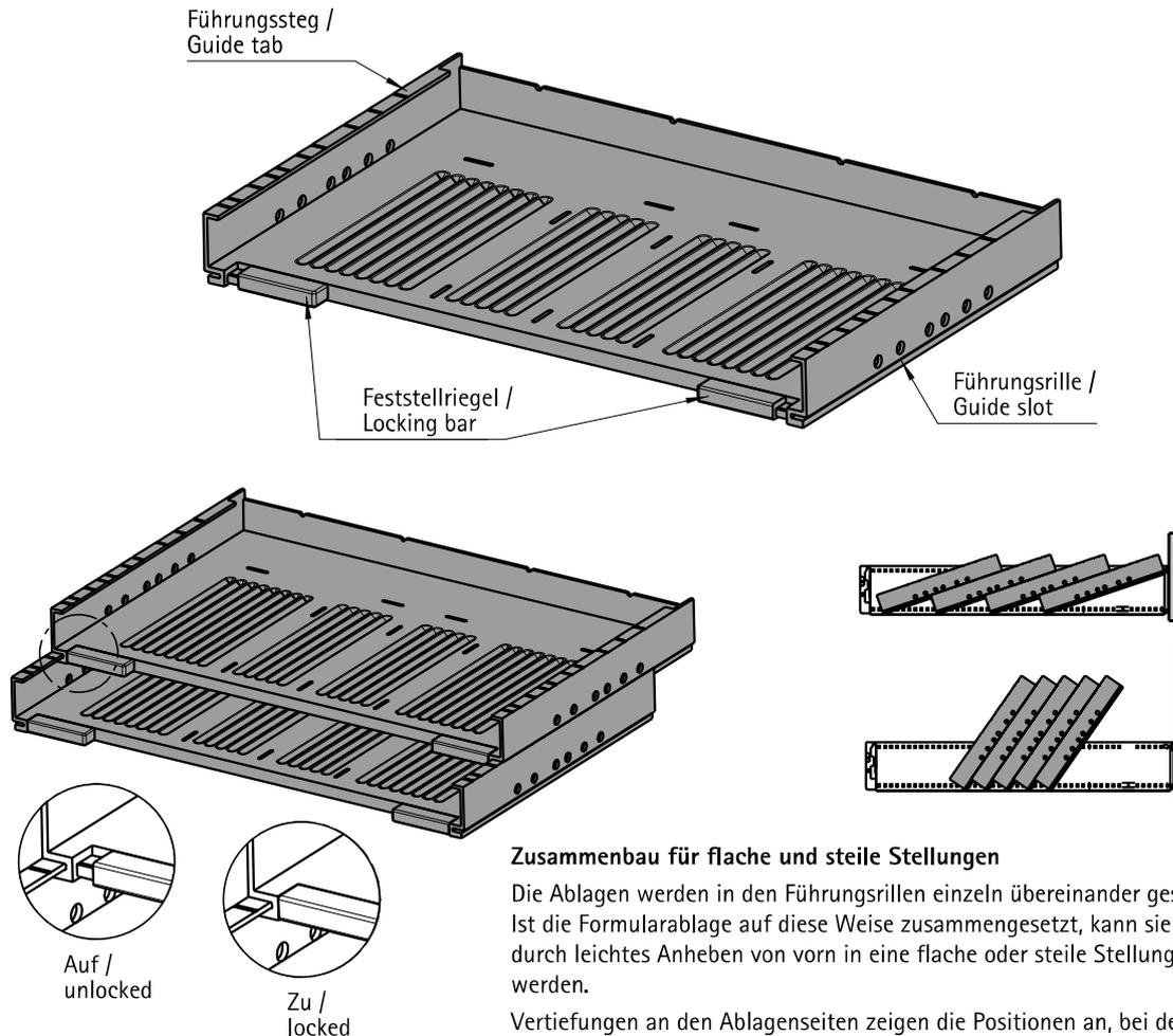
**Zusammenbau für flache und steile Stellungen**
