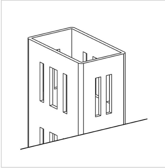
Montant à double perforation, au pas de 37mm.
