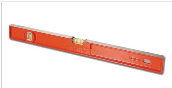
2 semelles usinées permettant de travailler avec précision corps massif en alliage d'aluminium léger et résistant fioles anti-chocs en Altuglass, incassables et réversibles fiole horizontale réglable peinture époxy résistante aux chocs et aux intempéries
