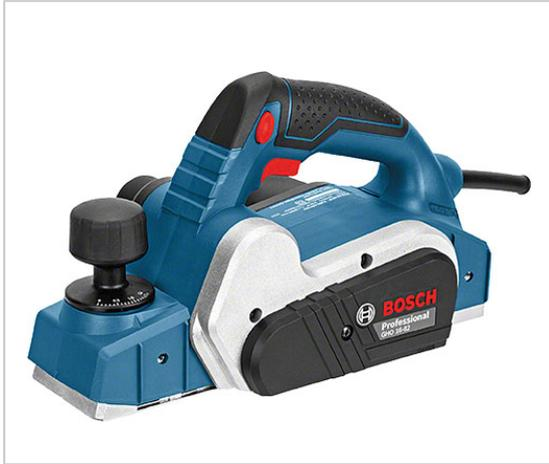
Poignée avec revêtement Soft Grip bouton lock-on qui empêche les redémarrages imprévus régime à vide : 18000 tr/min ajustement de la profondeur de rabotage de 0-1,6 mm épaisseur de feuillure réglable de 0-9 mm câble de 4 m livré avec sac à poussière, butée parallèle.
