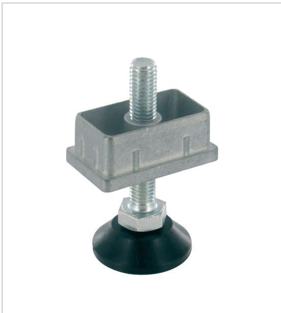
Vérin Ø 38mm avec tige filetée M10x60mm, et embout de finition zamac pour montant 50x30mm.
